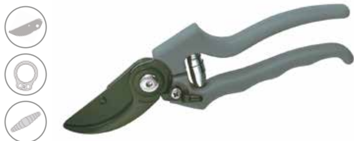
Forbice per potatura vigna 22 cm con lama teflonata intercambiabile. Impugnatura ergonomica con rivestimento antiscivolo, lama in acciaio al carbonio temprato HRC 54:56
