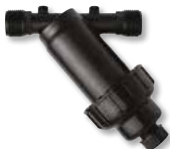
Cartuccia filtrante in acciaio inox 155 Mesh (100 Micron) Portata massima 80 L/min Pressione massima di esercizio 10 bar Corpo e tappo in Nylon Tappo di spurgo fil. 1/2" F per una pulizia rapida
